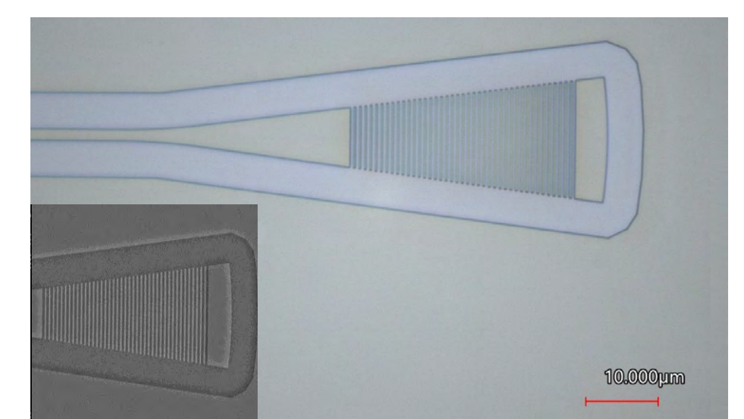
Beispiel für einen von AMO hergestellten Si 3 N 4 Gitterkoppler (rechts) mit Übergang in Wellenleiter (links). Links unten: REM-Aufnahme des Kopplers.
