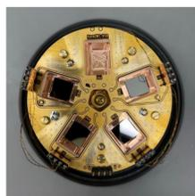
Messaufbau für Supraleiter-Dünnschicht-Proben
